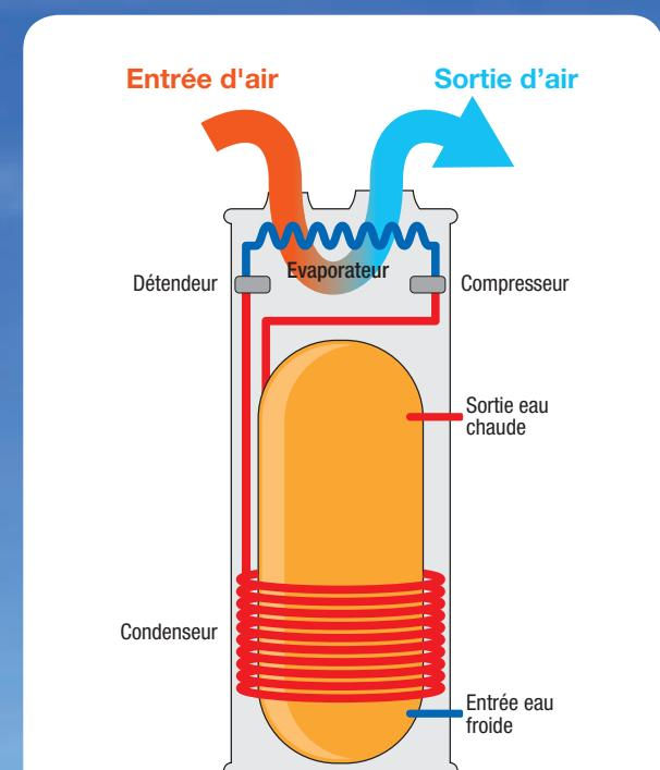
Un compresseur électrique assure la circulation d'un fluide à travers un réseau : évaporateur – compresseur – condenseur – détendeur.
